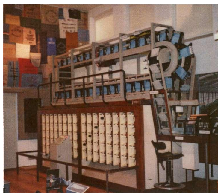
Afb 2. Kleine Transorma, uit Breda, thans voor demonstraties opgesteld in het Museum voor Communicatie. De wagentjes-ketting, boven de sorteervakken, is duidelijk herkenbaar.
